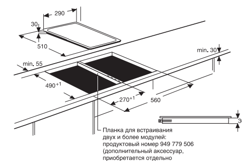
Схема встраивания ZDG 326 X, ZDK 320 X, ZDE 320 X
