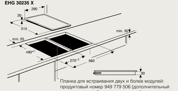
Схема встраивания газовых варочных поверхностей. Модели Luxline Domino: EHC 30200 X, EHV 30100 X, ENG 30835 X, ENG 30235 X
